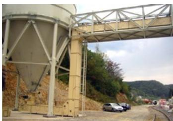
Winkelbecherwerke sind speziell ausgelegt, um Schüttgüter von einer oder mehreren Aufgabestellen zu einer zentralen Abgabestelle zu transportieren.
